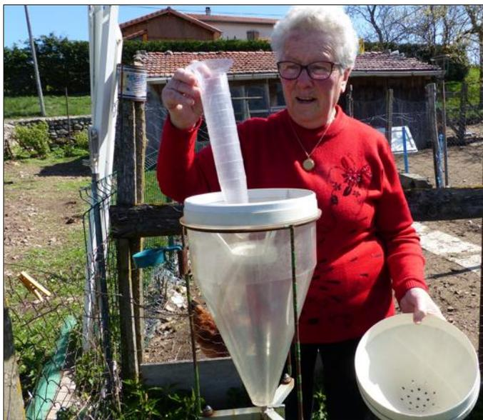
**Le pluviomètre est muni d'une éprouvette graduée jusqu'à 8 mm. Jeanine vide l'eau du pluviomètre autant de fois que nécessaire dans l'éprouvette pour mesurer la quantité d'eau de pluie.** Photo Le Progrès/Isabelle VERNAY
